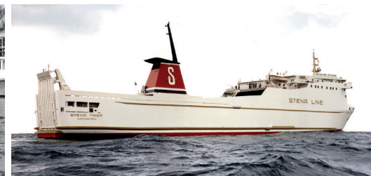
Abb. 13: RoRo-Hochseefährschiff STENA TENDER, 4.600 t Verdrängung, Baujahr 1977
