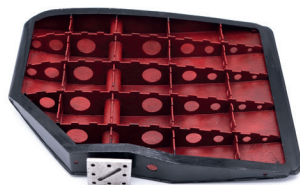
Abb. 15: Modell eines Tank-Balanceruders, ohne Datierung, Inv. Nr. 00021
