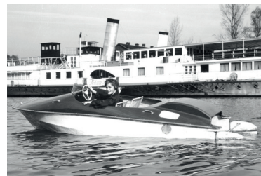
Abb. 12: Tretboot aus Polyester, Metallteile aus Niro-Stahl, um 1965
