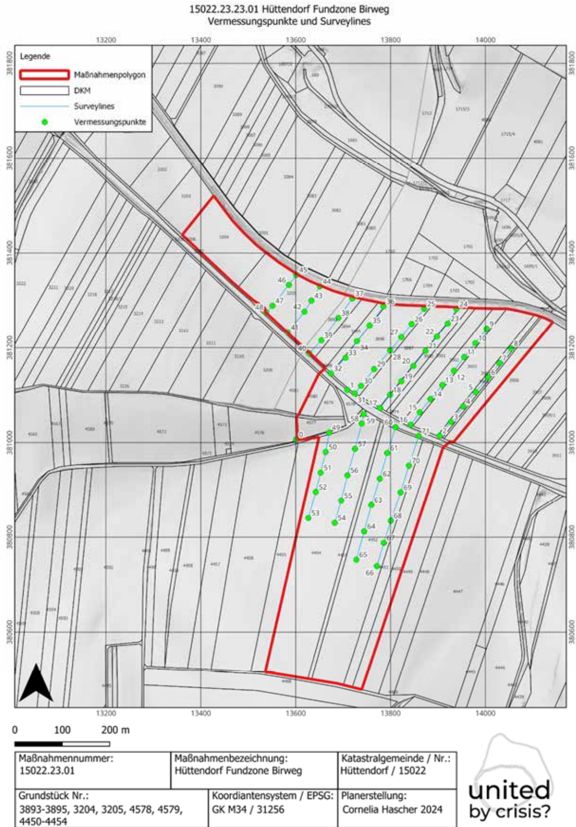
Abbildung 2: Surveylines und Messpunkte. Die Parzellen 4577-4580 sind eine Wiese und wurden nur locker abgeschritten.
