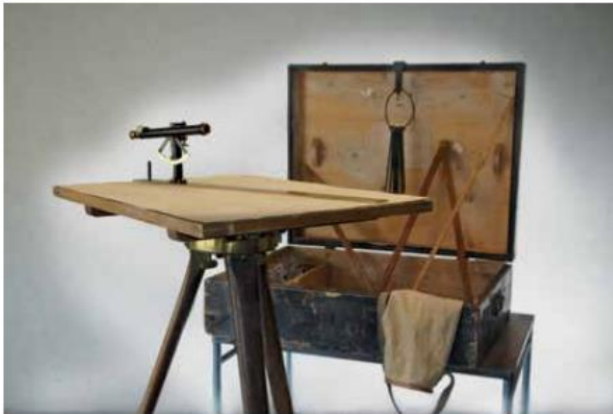
Abb. 33: Originaler Messtisch zur Erstellung des Franziszeischen Katasters
