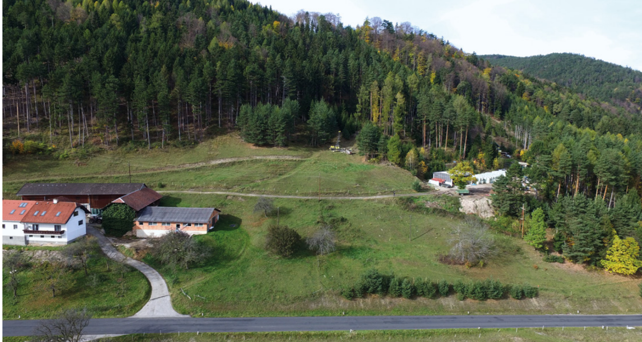
Luftaufnahme der Fundstelle Gasteil in der Gemeinde Priggwitz von Westen. Die bronzezeitlichen Bergbauhalden sind in der Böschung der Straße im Vordergrund deutlich zu erkennen. In der Bildmitte ist auf dem Scheitel der Halde das Bohrgerät aufgestellt (Kernbohrung 2). (Foto: Ronny Wessling)
